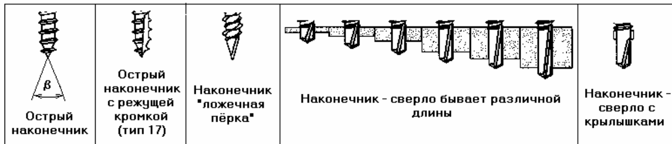
Рис.8. Типы наконечников шурупов и саморезов
