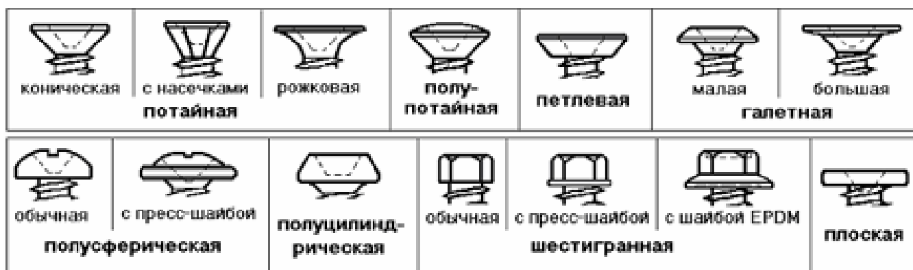
Рис.1. Типы головок шурупов и саморезов
